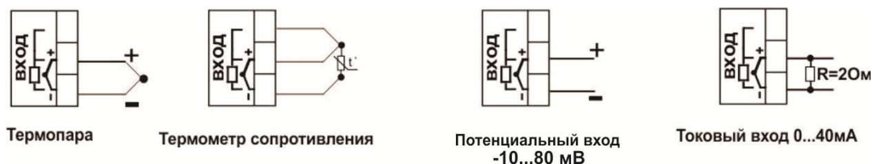
Рисунок 10 – Схема подключения датчиков температуры
